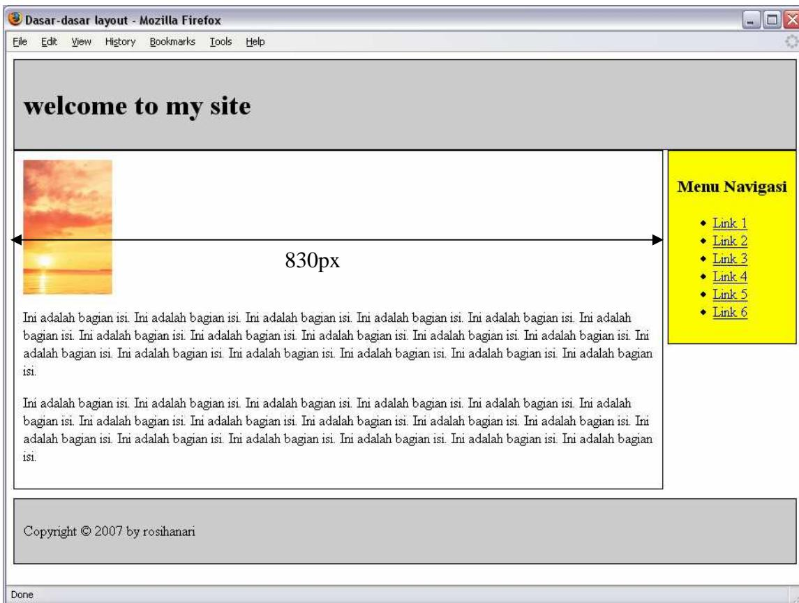
Pada gambar di atas tampak, bahwa bagian isi sudah memiliki sel sendiri selebar 830 pixel dan ada sedikit jarak (10 pixel) dari footer.
